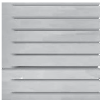
Рис. 7.10. Линейная структура, созданная на поверхности золота с помощью сканирующей туннельной микроскопии: параллельные прорезы шириной 0,8 нм расположены на расстоянии 2,4 нм одна от другой; площадь сканирования составляет 25 \times 25 \text{ нм}^2
