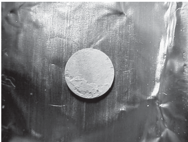
Рис. 2.3. Компактный образец нанокристаллического оксида ZrO_2 , приготовленный методом испарения, конденсации и компактирования, предложенным Г. Гляйтером [5, 8]. Диаметр образца 5 мм, толщина около 1 мм, средний размер зёрен в образце 20 нм (Институт теоретической и прикладной физики Штутгартского университета, Штутгарт, Германия)
