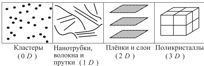
Рис. 2. Типы нанокристаллических материалов: 0D — (нульмерные) кластеры; 1D — (одномерные) нанотрубки, волокна и прутки; 2D — (двумерные) плёнки и слои; 3D — (трёхмерные) поликристаллы
